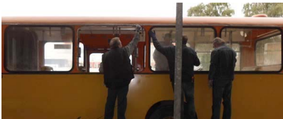
Vorbereitung zum Einbau der letzten Seitenscheibe.
